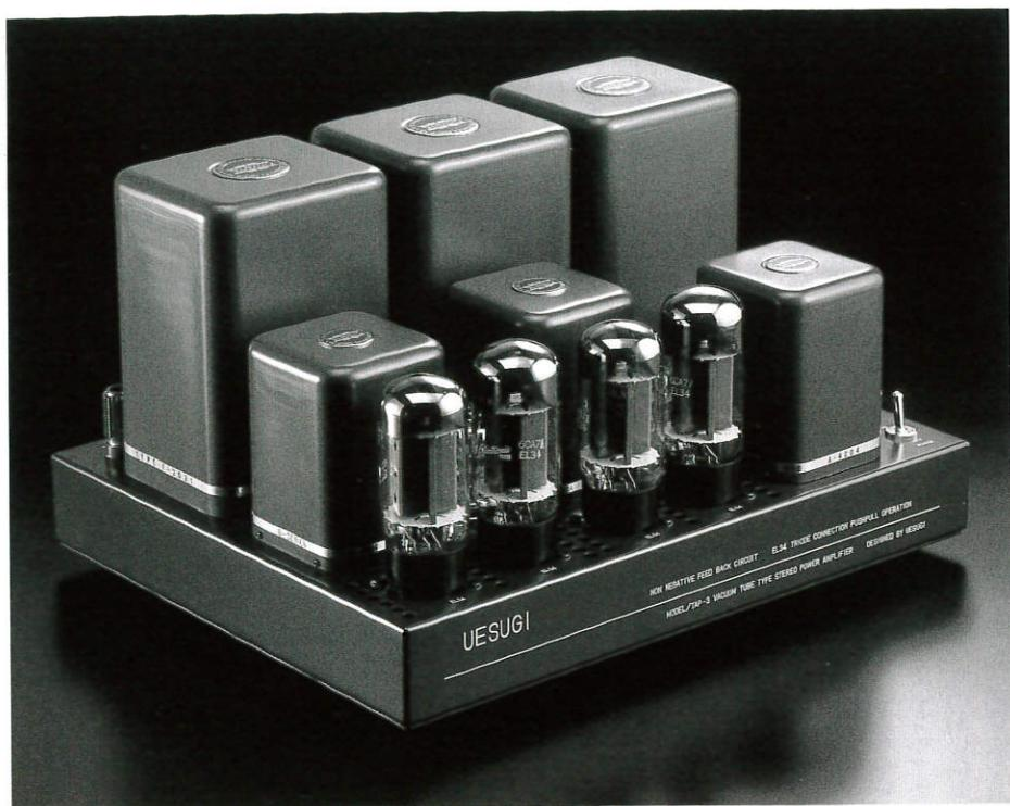
上杉佳郎氏が製作したEL34/6CA7プッシュプル・パワーアンプTAP-3。出力17.6W+17.6W。外形寸法:W340×H204×D272mm
