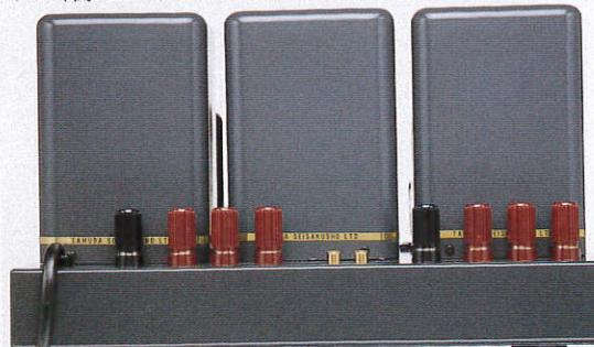
棚に設置したときに結線しやすいよう、後部上面に入出力端子を装備。
